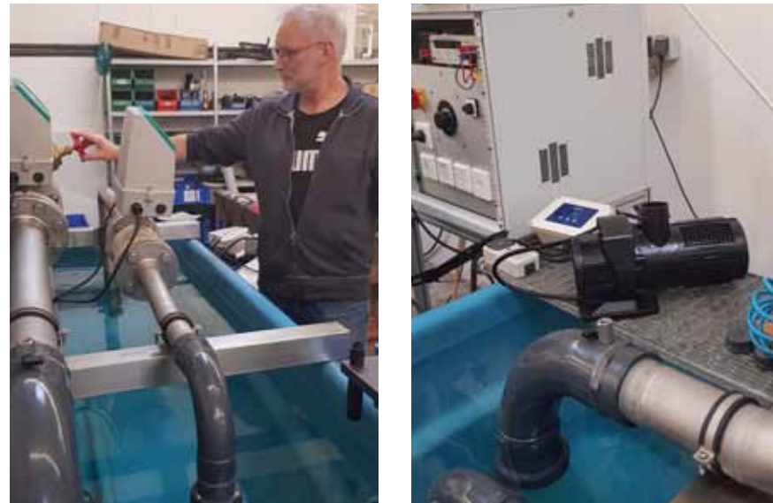
Capaciteit, druk en stroomverbruik meten op een geijkte testbank
